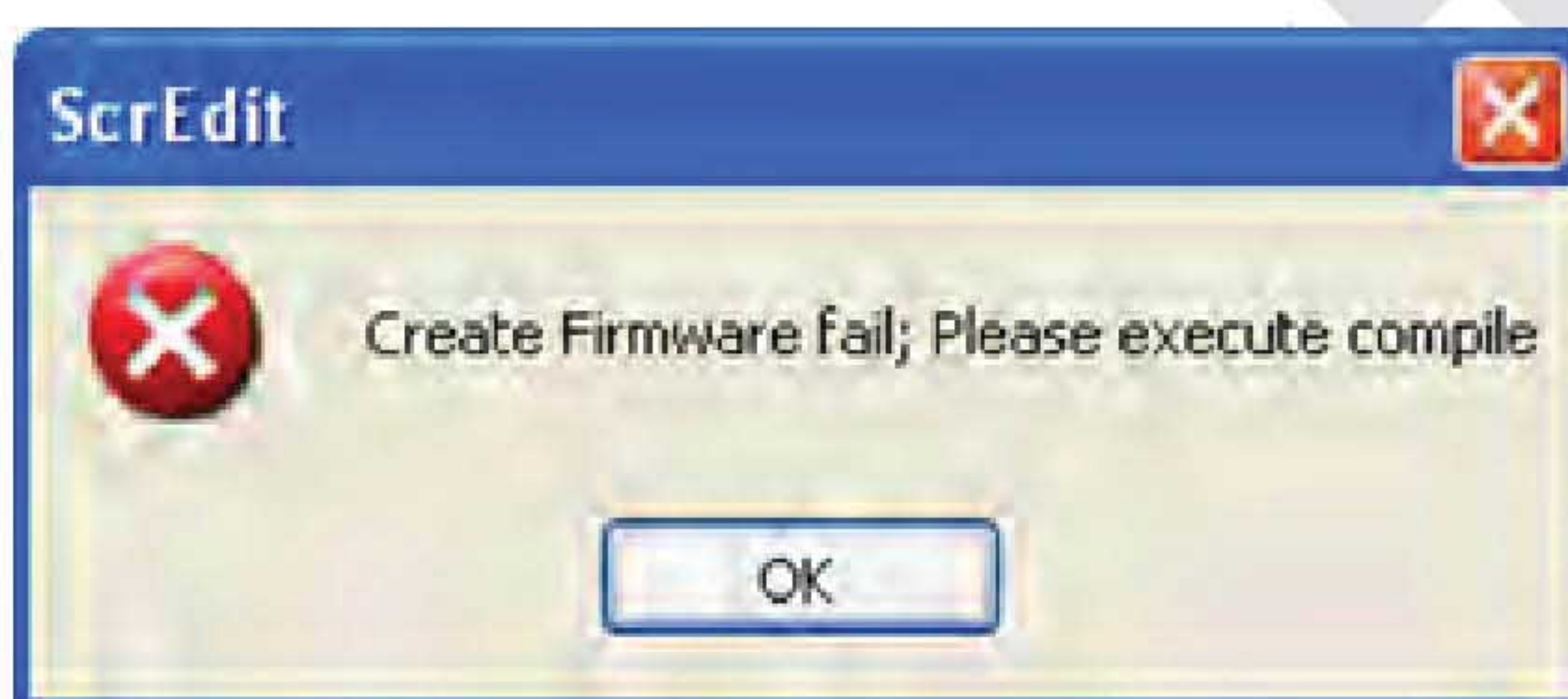
Рис. 3-5-7 Сообщение об ошибке при попытке записать на внешнюю память нескопированную прикладную программу
